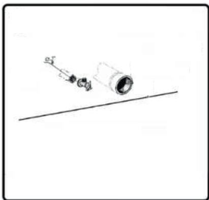
1. Coloque el tubo de drenaje y el tubo de alimentación en agua como se indica.
