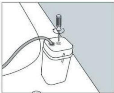
7. Despues de instalar la batería, atornille la tapa de la caja de baterías.
