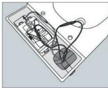
8. Coloque los dos cables de la válvula dentro de la caja blanca, y la caja de batería puede colocarse en el lado izquierdo o derecho del espacio de instalación.
