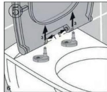
6. Puede desacoplar la tapa presionando dos botones en el interior de la tapa, como se ve en la imagen.
